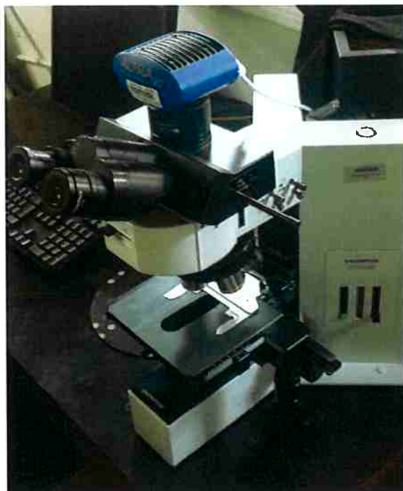
Figura 37 – Equipamento de microscopia utilizado neste trabalho de Formatura. Microscópio Olympus modelo BX60M.
