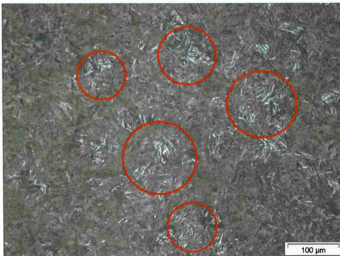
Figura 60 - Amostra aço 5160. Tratamento Isotérmico no dilatômetro a 350°C. Microestrutura majoritariamente composta por bainita inferior com presença de alguns grãos de ferrita alotriomorfas e de Widmanstätten \alpha_w (Círculos vermelhos). Ataque Nital 2%. [23; 24; 25]
