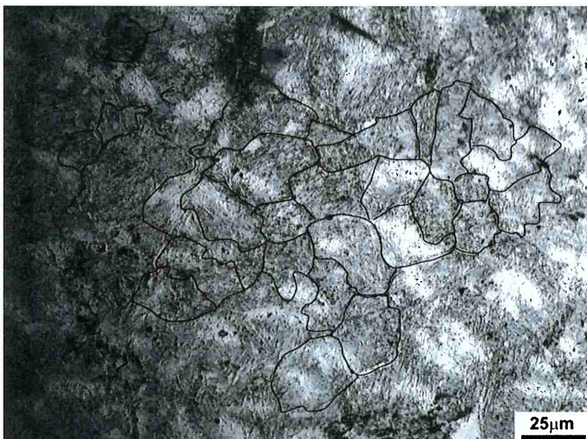
Figura 74 – Micrografia do aço SAE 5160 após ataque com a solução de ácido pícrico com hidróxido de sódio. Linhas escuras (feitos à mão) percorrem o traçado dos os contornos de grão que estavam visíveis. Tamanho de Grão Austenítico de 6 – 7 na escala ASTM. Ataque Nital 2%.
