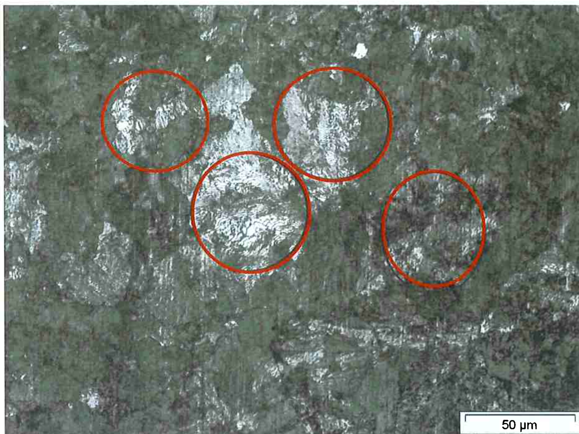
Figura 42 - Micrografia da amostra em microscopia ótica estado “Como Recebida” aço SAE 6150. Amostra composta por grãos de Perlita. Destacado na imagem (círculos vermelhos) colônias de perlita visíveis por conta da orientação cristalográfica do grão. Ataque Nital 2%
