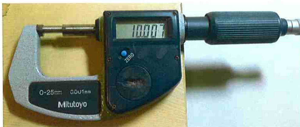
Figura 36 – Amostra tendo seu comprimento aferido com auxílio de um micrômetro.
