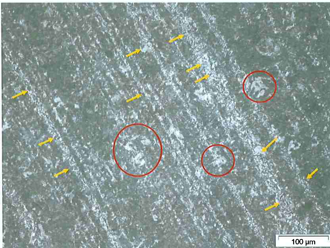
Figura 62 - Amostra aço 5160. Tratamento Isotérmico no dilatômetro a 500°C. É possível identificar uma microestrutura bandeada (Indicativo de Segregação). Microestrutura mista de Bainita + Perlita (início de sobreposição da região) + Ferrita (Alotrimórficas – Círculos Vermelhos; Acicular – setas amarelas). Há um certo alinhamento na microestrutura o que sugere a direção de laminação. Ataque Nital 2%. [23; 25]
