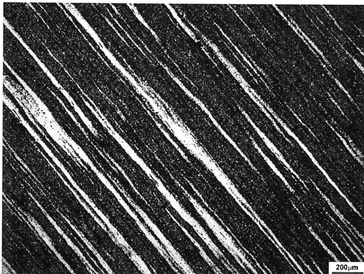
Figura 55 – Micrografia da amostra de aço 6150 ensaiada a 500°C. É possível observar um grande bandejamento nesta amostra (Indicativo de Segregação). As regiões brancas correspondem à Martensita. Já as porções escuras representam as porções de Bainita (austenita que foi transformada Bainita). Ataque Nital 2%.
