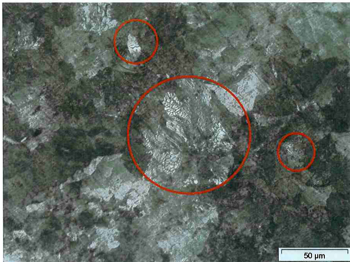
Figura 40 - Micrografia em microscopia ótica estado “Como Recebida” aço SAE 5160. Amostra composta por grãos de Perlita. Destacado na imagem (círculos vermelhos) colônias de perlita visíveis em virtude da orientação cristalográfica. Ataque Nital 2%.
