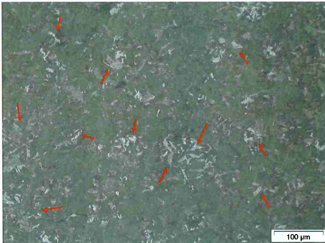
Figura 61 - Amostra aço 5160. Tratamento Isotérmico no dilatômetro a 425°C. Microestrutura mista de Bainita com porções de ferrita (setas vermelhas). Ataque Nital 2%. [23; 24; 25]
