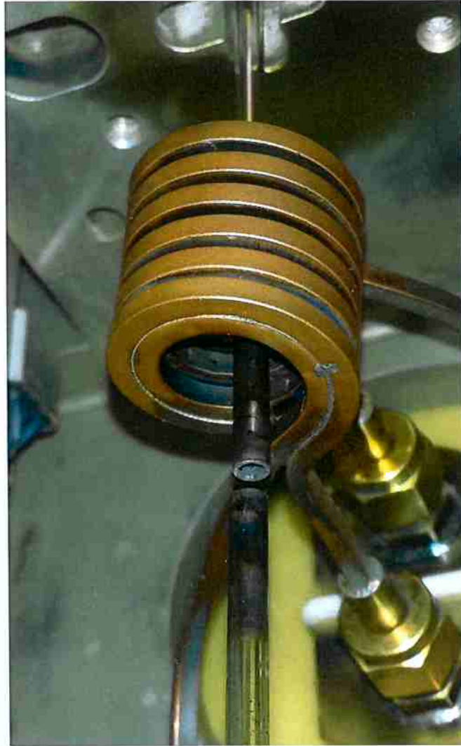
Figura 24 – Bobina de Indução existente no dilatômetro DIL 805. Também é possível observar as hastes de sílica.
