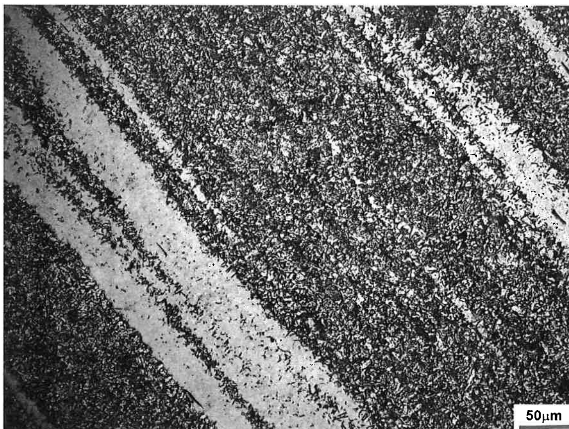
Figura 56 - Micrografia da amostra de aço 6150 ensaiada a 500°C. É possível observar um grande bandejamento nesta amostra (Indicativo de Segregação). As regiões brancas correspondem à Martensita. Já as porções escuras representam as porções de Bainita (austenita que foi transformada Bainita). Ataque Nital 2%.
