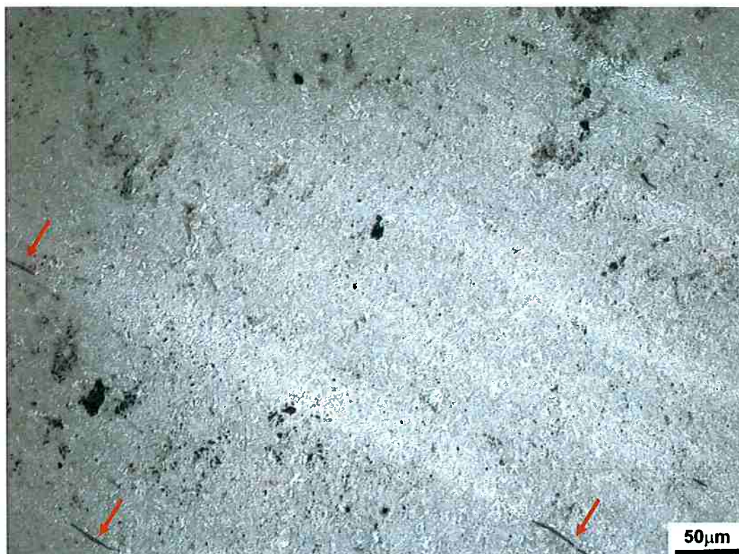
Figura 66 - Amostra aço 6150. Tratamento Isotérmico no dilatômetro a 400°C. Há presença de Bandeamento (Ferrita e Bainita) [4; 23] e algumas inclusões provavelmente de Sulfetos de Manganês (Setas Vermelhas). Pontos são marcas de oxidação. Ataque Nital 2%.
