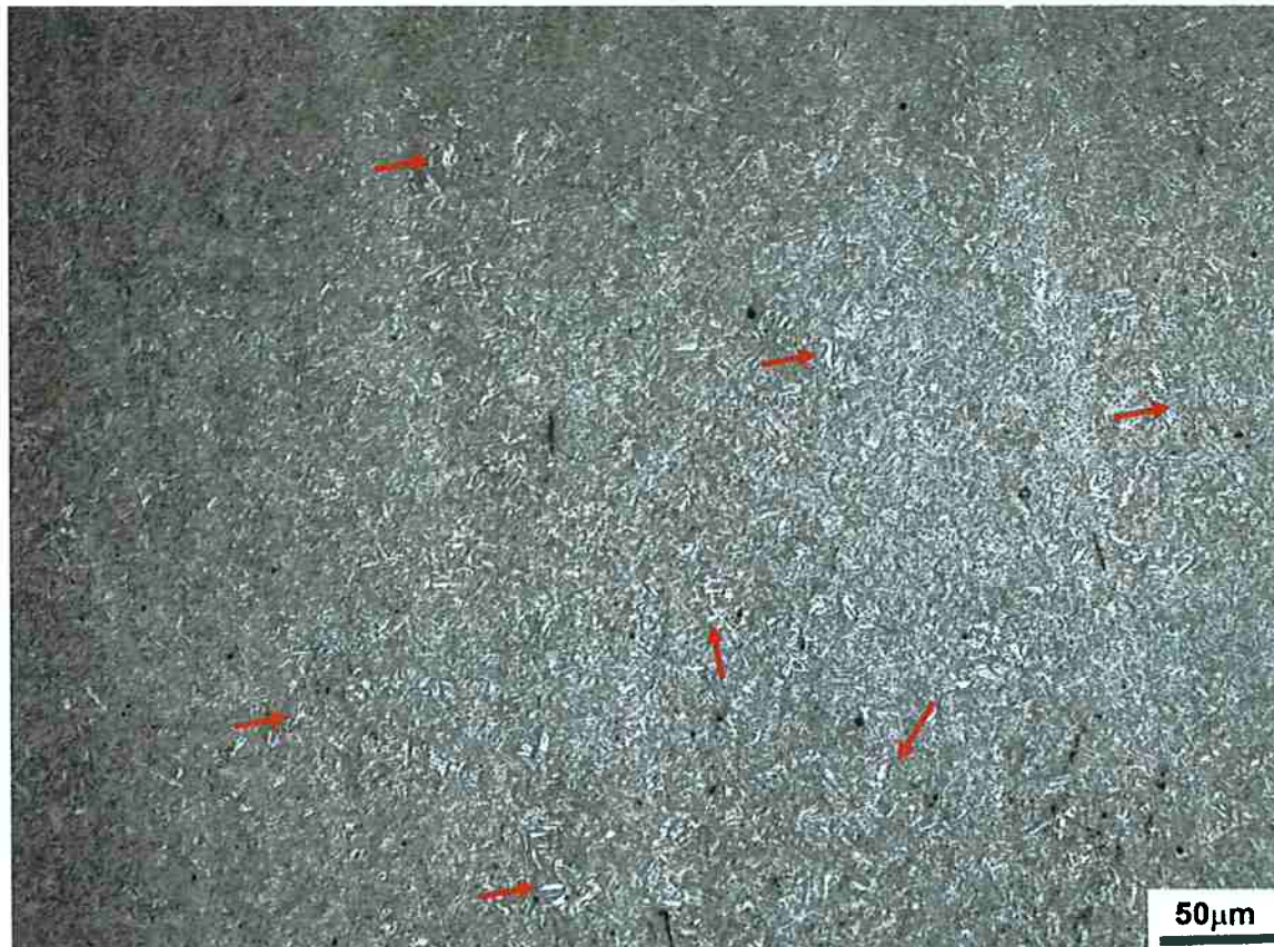
Figura 65 - Amostra aço 6150. Tratamento Isotérmico no dilatômetro a 350°C. Microestrutura formada por Bainita inferior e por regiões com Ferrita (Setas Vermelhas) [23] . Ataque Nital 2%.
